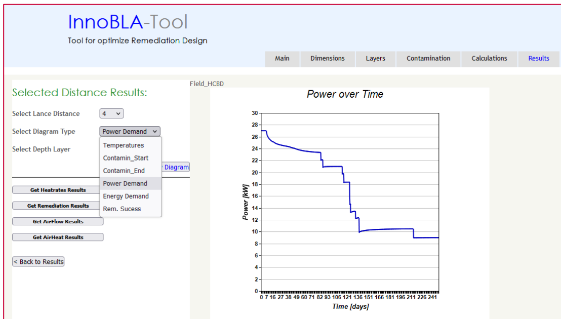
Abbildung 144 Ergebnisse Heizleistungen für einen ausgewählten Heizpflanzenabstand
