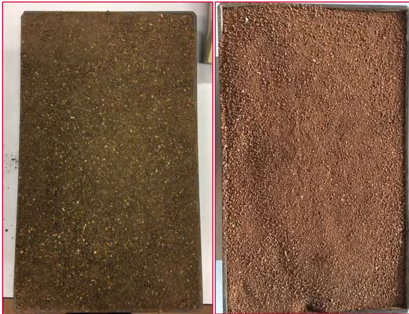
Abbildung 227 Vor (links) und nach (rechts) thermischer Behandlung, ST32 mit 300 °C
