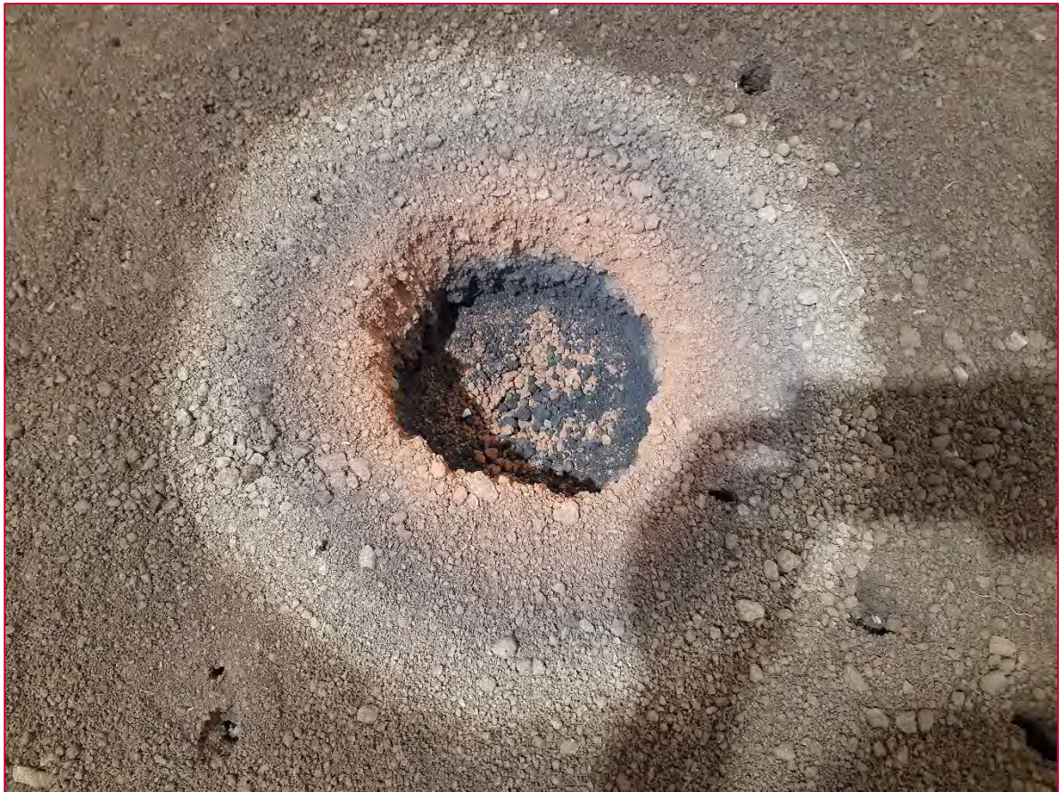
Abbildung 81 Detailfoto des getrockneten und pyrolysierten Bereichs.
