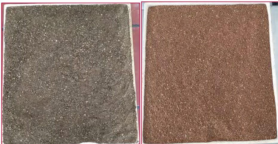
Abbildung 228 Vor (links) und nach (rechts) thermischer Behandlung, ST32 mit 500 °C
